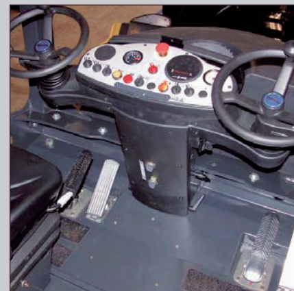
Два укомплектованных рабочих места оператора с поворотным-выдвижным сиденьем делают работу более эффективной и обеспечивают хорошую видимость.
