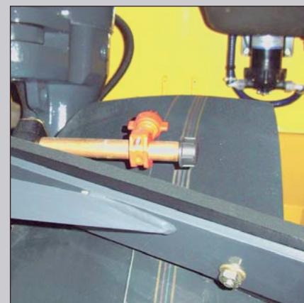
Стандартное оборудование: под давлением разбрызгивание обеспечивает однородное смачивание - независимо от перепадов или уровня воды в баке.
