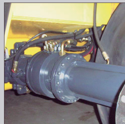
Чувствительный контроль скорости, с помощью гидростатического привода
