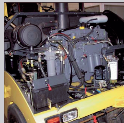
Легкое и быстрое техническое обслуживание: свободный доступ к двигателю обеспечен со всех сторон.
