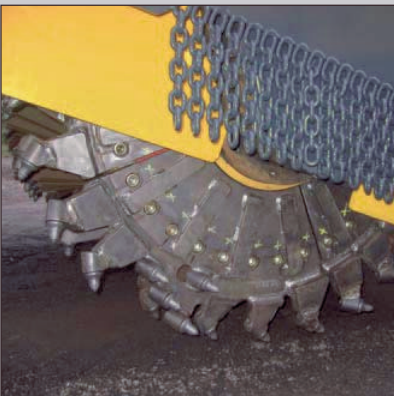
Универсальный ротор с сегментами кромки, предусмотрена возможность единичной замены
