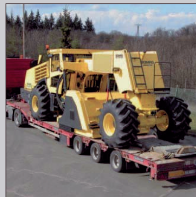
Простая транспортировка машины благодаря возможности регулировки платформы оператора по высоте.
