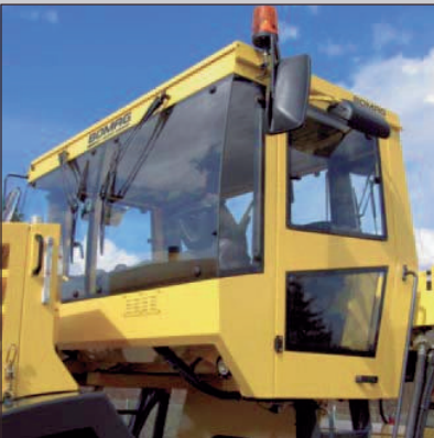
Платформа оператора и кабина с интегрированными системами ROPS/FOPS.
