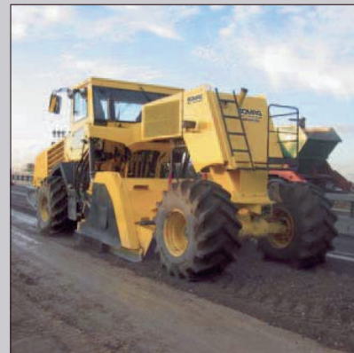
При эксплуатации в качестве ресайклера в качестве опции предусмотрена система впрыска эмульсии битума или вспененного битума.
