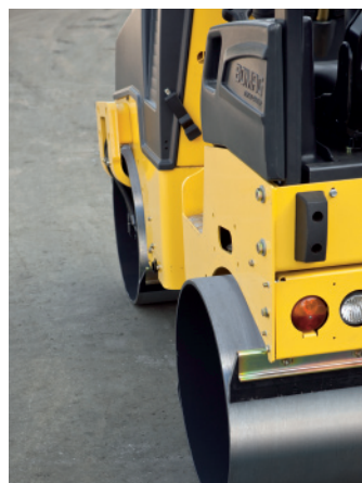
Катки с односторонним креплением вальца и смещением на 60 мм.
