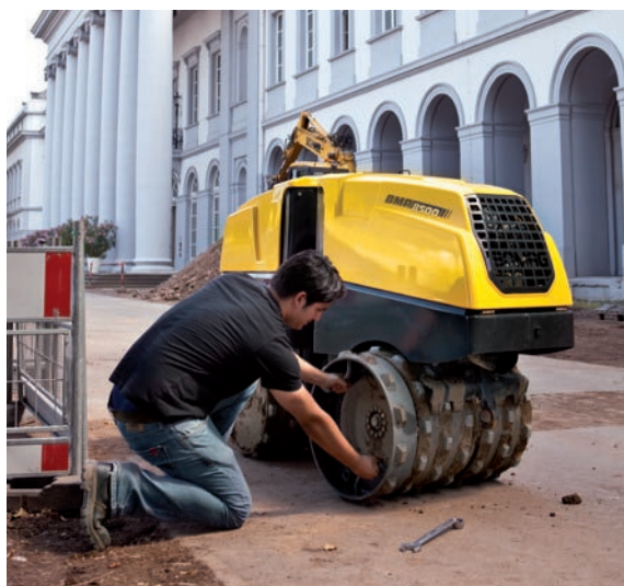
Дополнительные насадки на валец помогут быстро подстроить рабочую ширину под более узкую или широкую ширину канавы.
