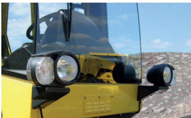
Освещение в соответствии с правилами допуска транспортных средств к движению на дороге.
