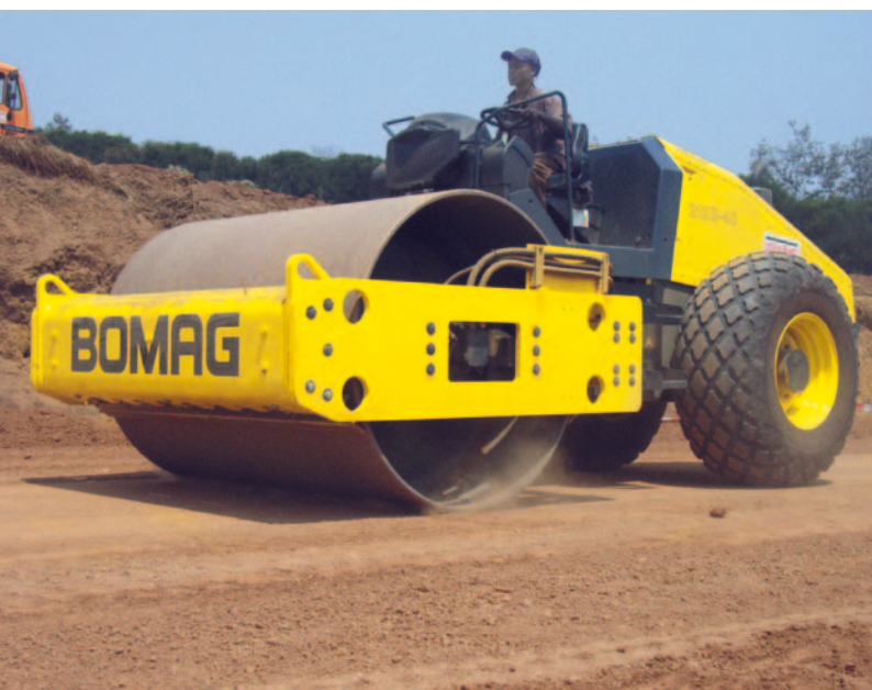
Гладкий валец при использовании на песчаном грунте.
