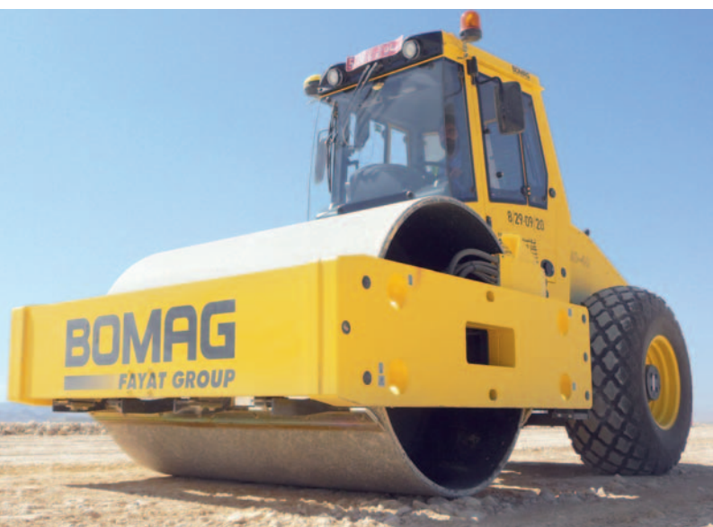
Каток BW 218 D-40 уплотняет слои до 1,30 м.
