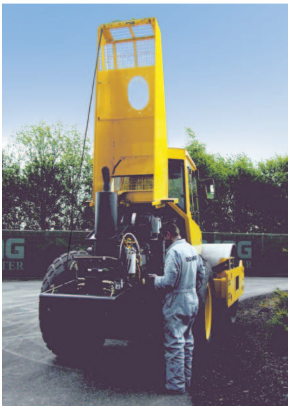
Дотянуться к узлам для проведения технического обслуживания можно с земли, а капот можно открыть вручную.
