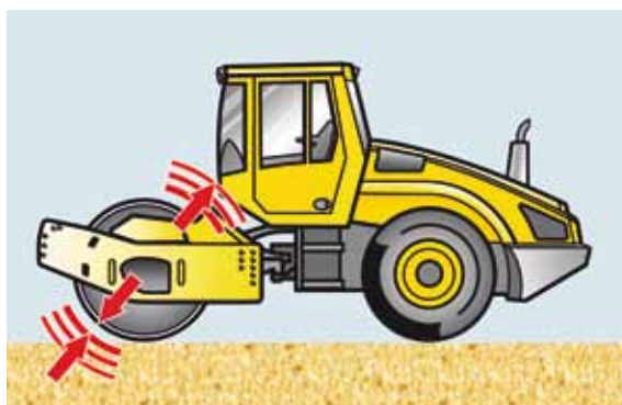
Положение угла = согласованная энергия уплотнения
