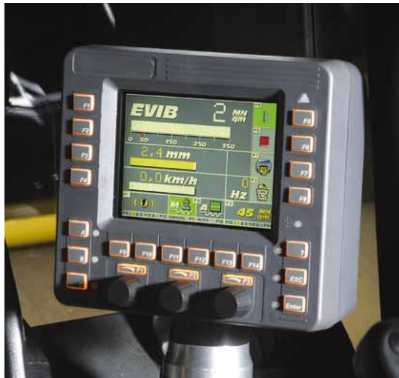
Четкое отображение на дисплее показывает водителю, когда оптимально уплотнен грунт.
